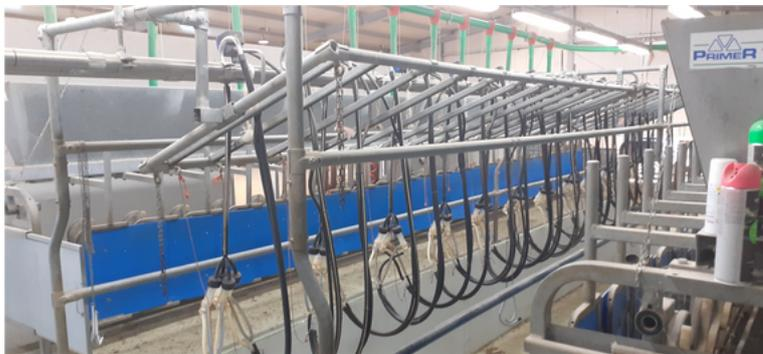
La machine à traire est un équipement clé au regard de la qualité microbologique du lait, en particulier pour les transformateurs de lait cru.
